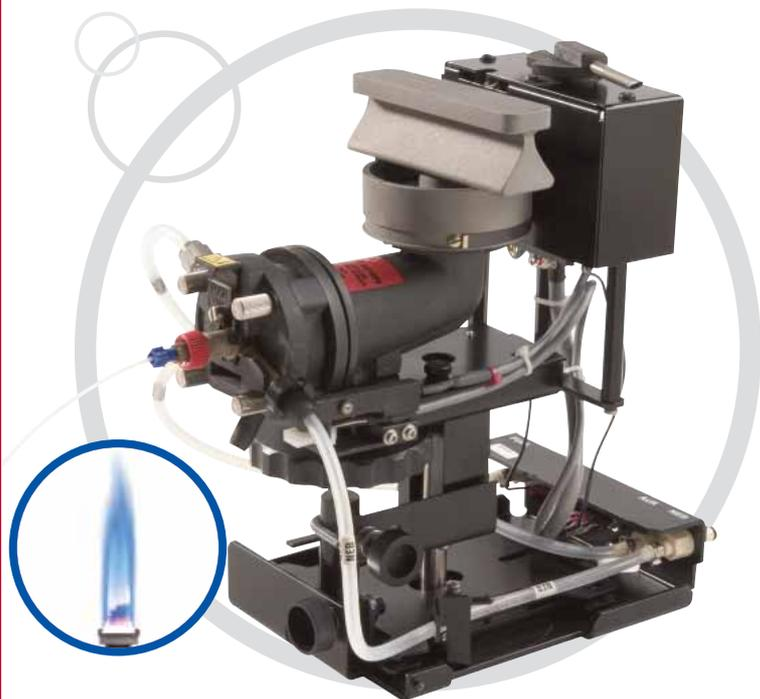
高效的燃烧头系统对于您的AA仪器获得最佳性能非常重要，同时正确的维护对于获得精密、准确的检测结果也是必需的。
