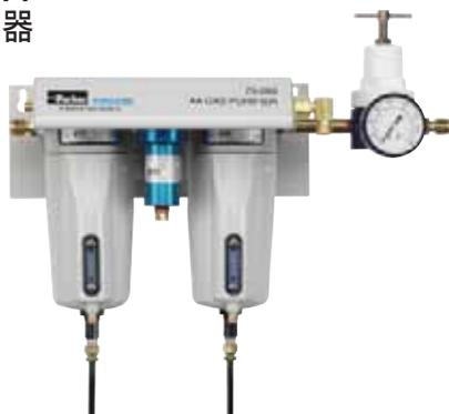
空气净化组由一个Balston级DX凝聚过滤器和一个Balston级 BX凝聚过滤器组成。这两个过滤器一起把油、水和微粒污染物 (99.99% 0.01微米大小) 从压缩空气中去除。
