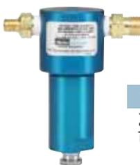
用于原子吸收光谱实验室，该过滤器包括一个Balston级BQ过滤器筒来从乙炔中去除99.99% 0.01微米大小的液体和固体污染物。最大工作压力：15 psig。
