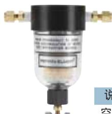
用于原子吸收光谱和等离子发射光谱实验室，该过滤器专门为从压缩空气中除去水、油和直径最小0.6微米的污染颗粒而设计。推荐用于用油压缩机以及从无油压缩机所用空气中去除水分和污染颗粒。
